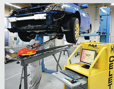
リフトを使用した入庫&完成検査
