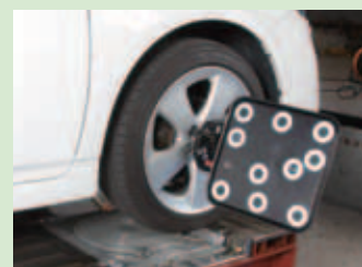
③車両を前方に移動し、 ターゲットが前方30° 傾いたところで停止
