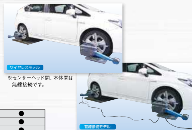
有線接続モデル ※センサーヘッド間、本体間は有線接続です。
