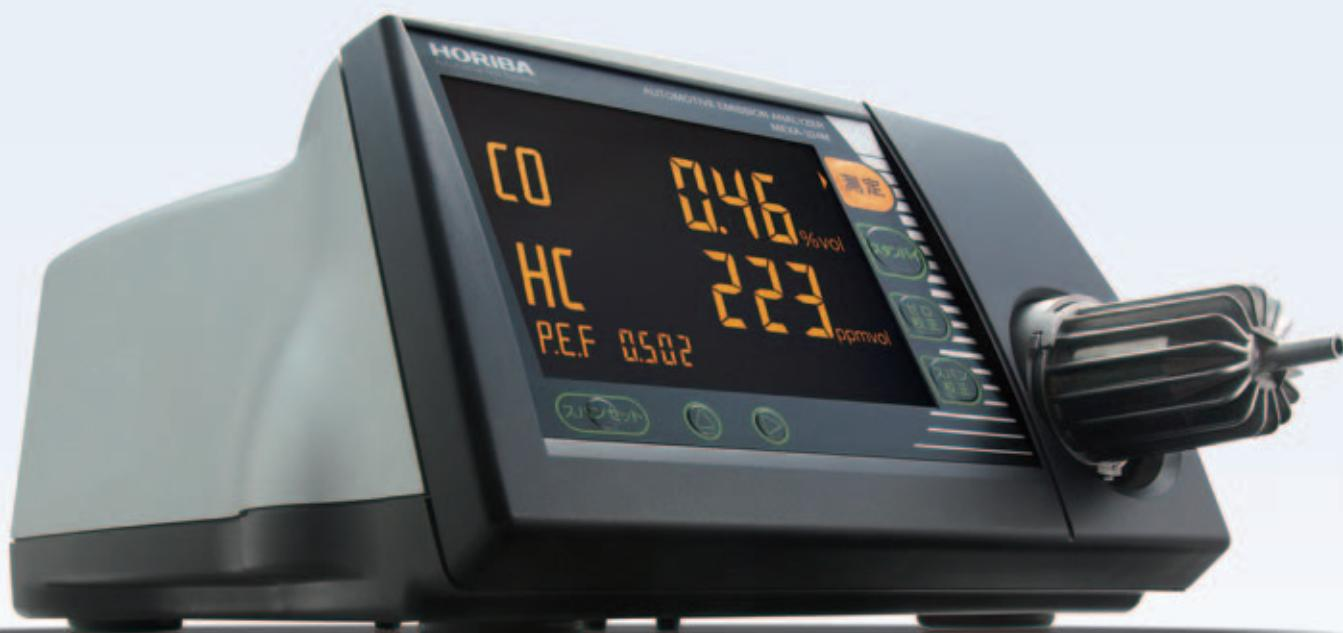
自動車排ガス中の一酸化炭素(CO)と炭化水素(HC)を、非分散赤外線吸収(NDIR)法により、簡単に、かつ高精度で測定します。自動車整備工場での検査・点検中はもちろん、一般的なエンジン調整作業時など、正確な排ガス濃度が素早くわかります。
