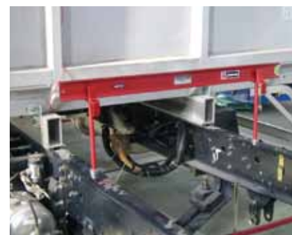
水準器で全体の曲がり確認
