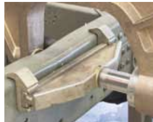
フランジ面局部曲がり修正 (40t)
