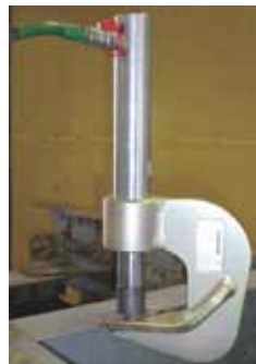
フランジ面局部曲がり修正 (10t)
