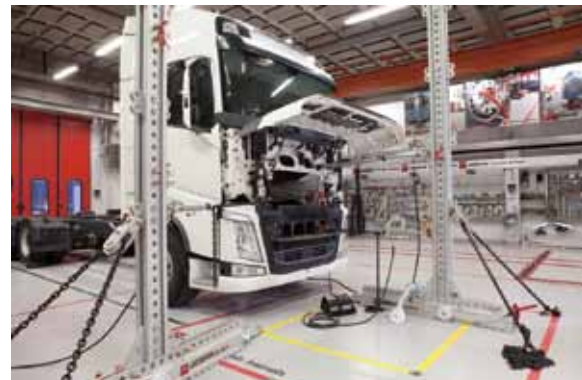
フロアアンカー固定(多方向引き) ※フロアアンカー固定に必要な構成品は別途お問い合わせください。
