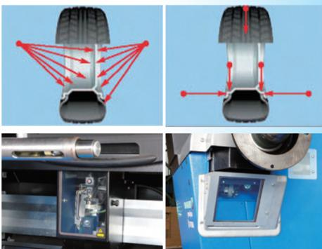
通常は、測定ゲージや手動入力をしていたホイール寸法入力を、3方向レーザー計測システムを使用し、タイヤ・ホイールに一切触れる事無くホイール寸法を正確に測定・入力します。
