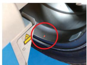
ウェイト貼付け位置をレーザーで指示するので、正確なウェイト貼付け作業が行なえます。
