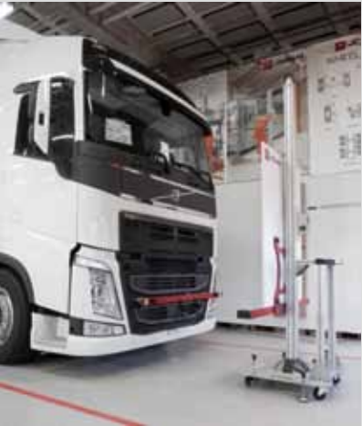
ヨサム カムアライナーを用いたVOLVO FLS/LPOS作業例
