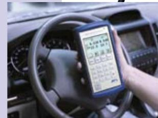
表示器・操作ユニットがハンディタイプ・無線式(Bluetooth)で、運転席から操作でき、測定結果も確認できます。
